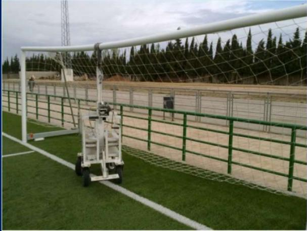
Figura 1. Prueba de resistencia en porterías.
